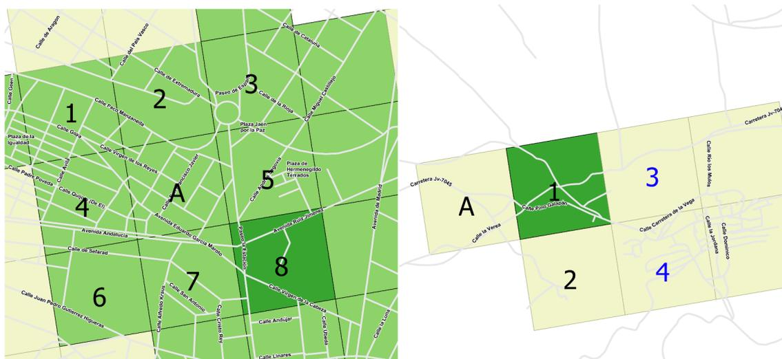
**Ilustración 1. Esquema de vecindades para la estimación de la RMES de una celdilla A**
