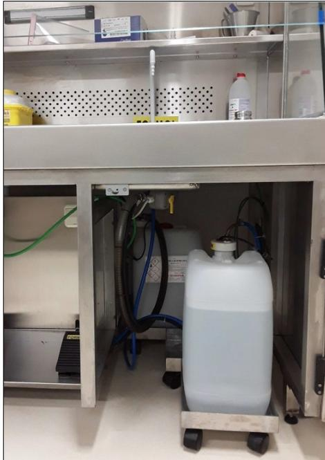
Bidones para suministro de formol mediante accionamiento por pedal:
