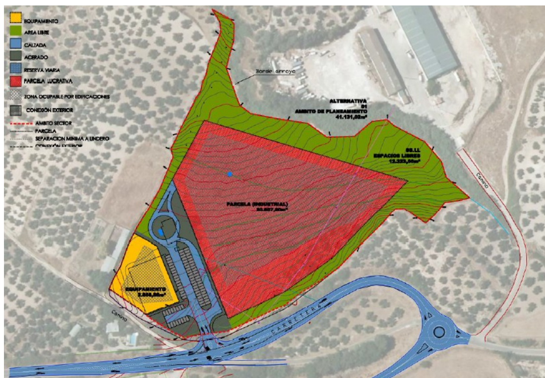
Zonificación de la alternativa 1, valorada como la más adecuada y con menor afección a cauce.
