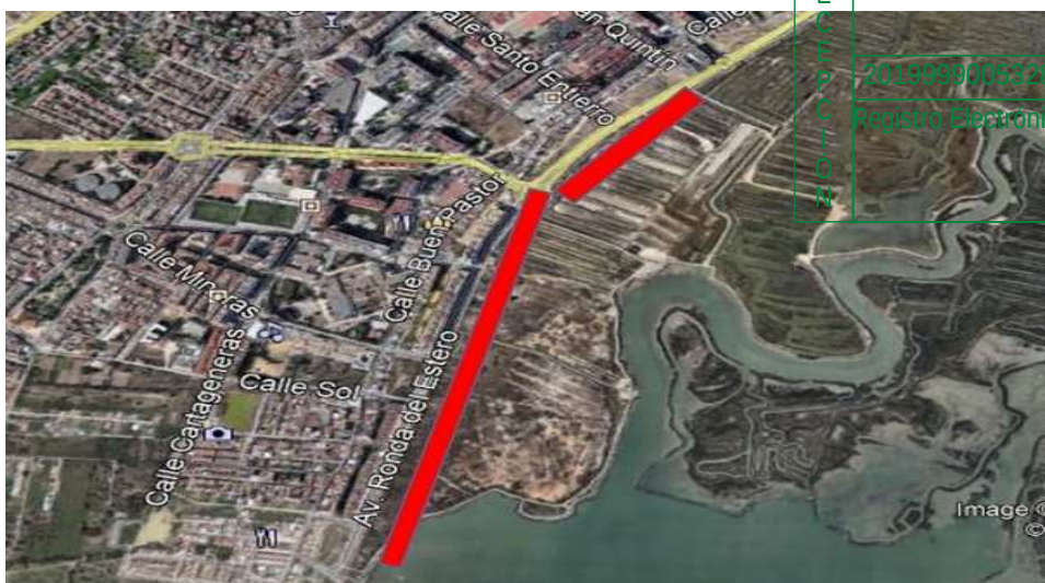
Foto 13. En rojo ubicación del canal que se propone paralelo a la ronda del estero y que se llenará de agua de forma natural para conseguir un efecto foso. La posición de los rectángulos es aproximada y el tamaño ha sido ampliado para su visualización.
