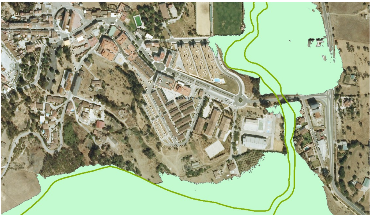
Delimitación técnica del Dominio Público Hidráulico del Tributario 2 y su zona inundable correspondiente a la avenida de 500 años facilitada por la Administración Hidráulica Andaluza al Ayuntamiento de Jimena de la Frontera.
