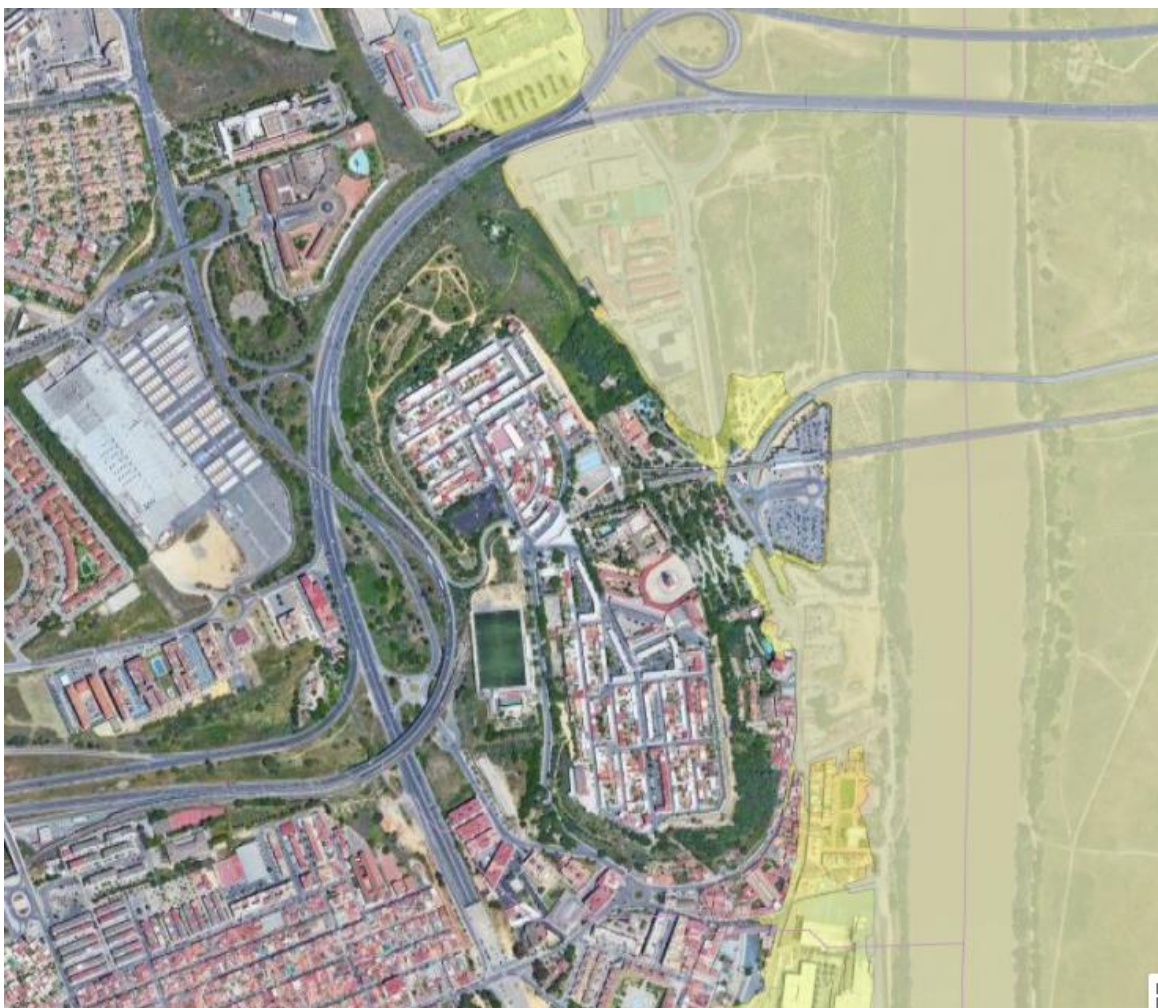
Cartografía de Zonas Inundables del Sistema Nacional de Cartografía de Zonas Inundables (SNCZI) ( https://idechg.chguadalquivir.es/ ). Zona de flujo preferente (gris) Lamina inundación Q500 años (gris)
