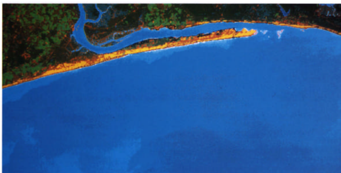
Figura 9.3.: Superposición de la línea de costa de 1956 (negro) sobre la costa actual obtenida por clasificación de una imagen Landsat-TM.
