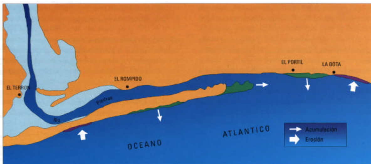
Figura 9.2.: Principales modificaciones de la línea de costa en el sector Terrón-La Bota (Huelva), entre 1956 y 1985.
