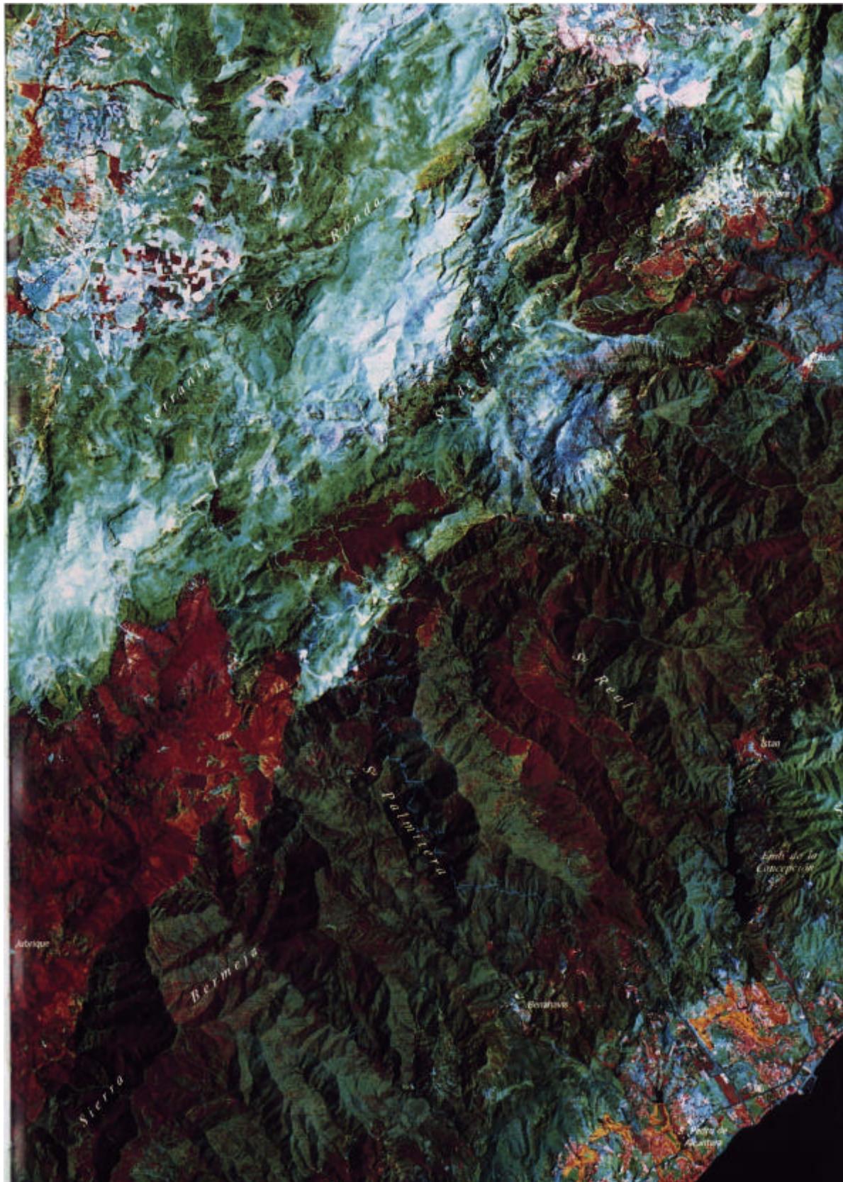
Imagen de satélite Landsat-TM de fecha 26-07-87. Escala 1/125.000. Falso color infrarrojo (3-5-4). @ ESA. Earthnet. 1990.
