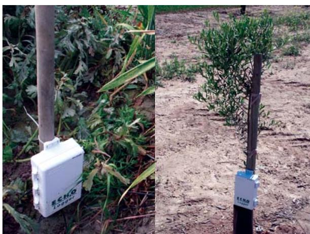
Sondas de humedad instaladas a un Data Logger
