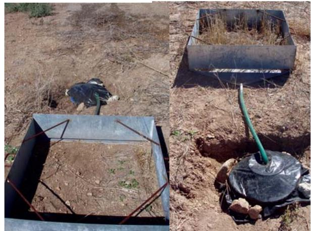
Foto 5. Detalle de los tanques, en el de la izquierda se observa el rastrojo (A. Conservación) y en el de la derecha, el suelo desnudo (A. Convencional)
