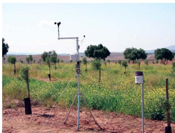
Estación meteorológica instalada en la finca Malduenda
