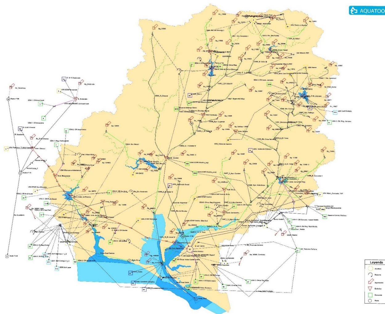
Figura nº 14. Topología del modelo de simulación del Sistema de Explotación Huelva para el horizonte 2039
