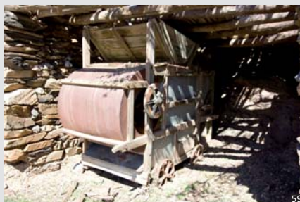
Aventadora en desuso
