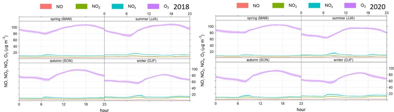
**Figura 6.20. Patrón horario estacional para O<sub>3</sub>, NO<sub>x</sub>, NO<sub>2</sub> y NO en 2018 y 2020. Estación Rodalquilar**
