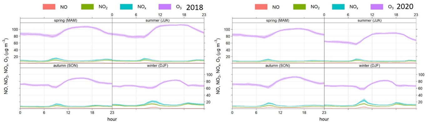
**Figura 6.18. Patrón horario estacional para O<sub>3</sub>, NO<sub>x</sub>, NO<sub>2</sub> y NO en 2018 y 2020.
