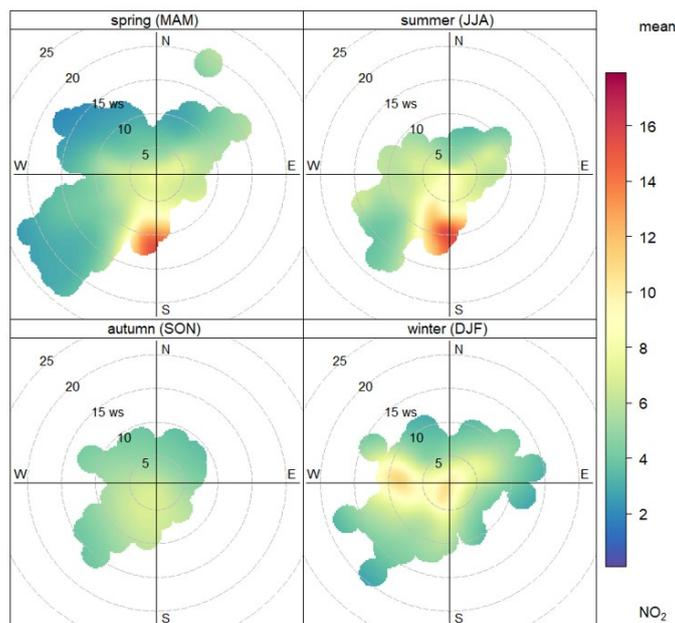
**Figura 6.22. Relación entre los niveles horarios de NO<sub>2</sub> y la velocidad y dirección del viento en 2018. Estación Plaza del Castillo**
