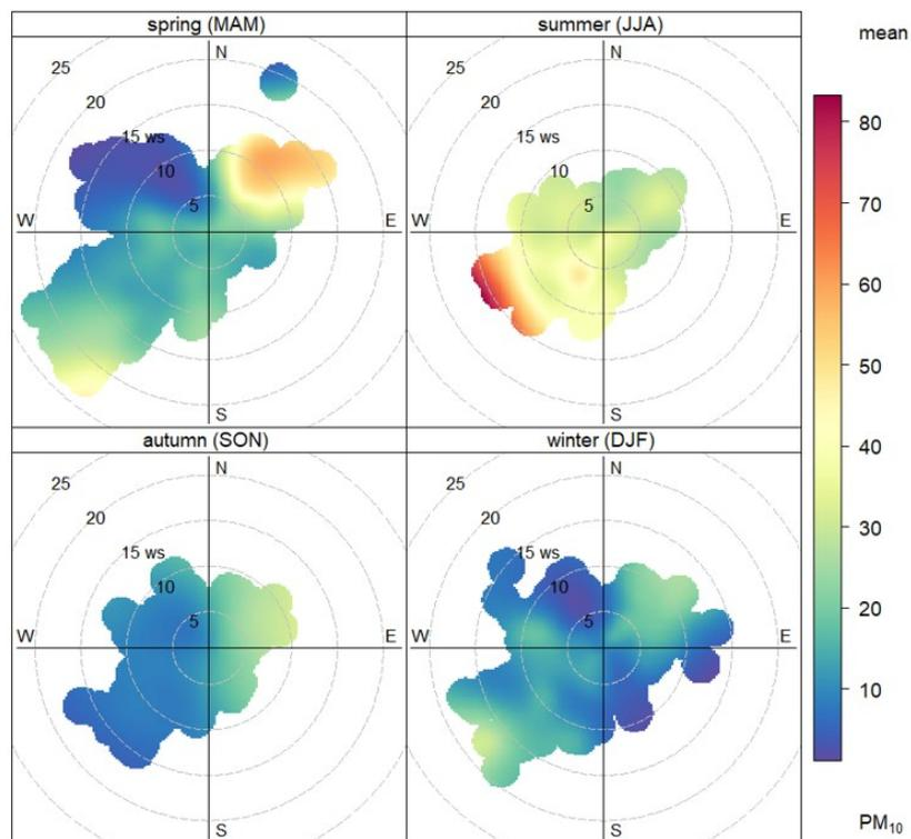
**Figura 6.21. Relación entre los niveles horarios de PM<sub>10</sub> y la velocidad y dirección del viento en 2018. Estación Plaza del Castillo**
