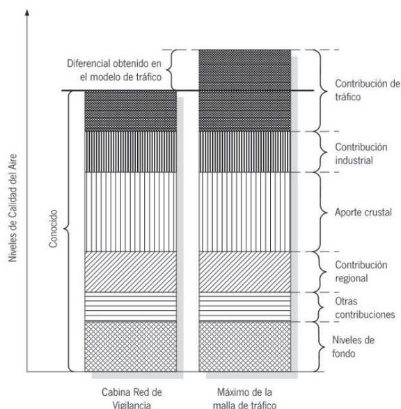
Figura 0.8 Selección del máximo valor de concentración alcanzado.
