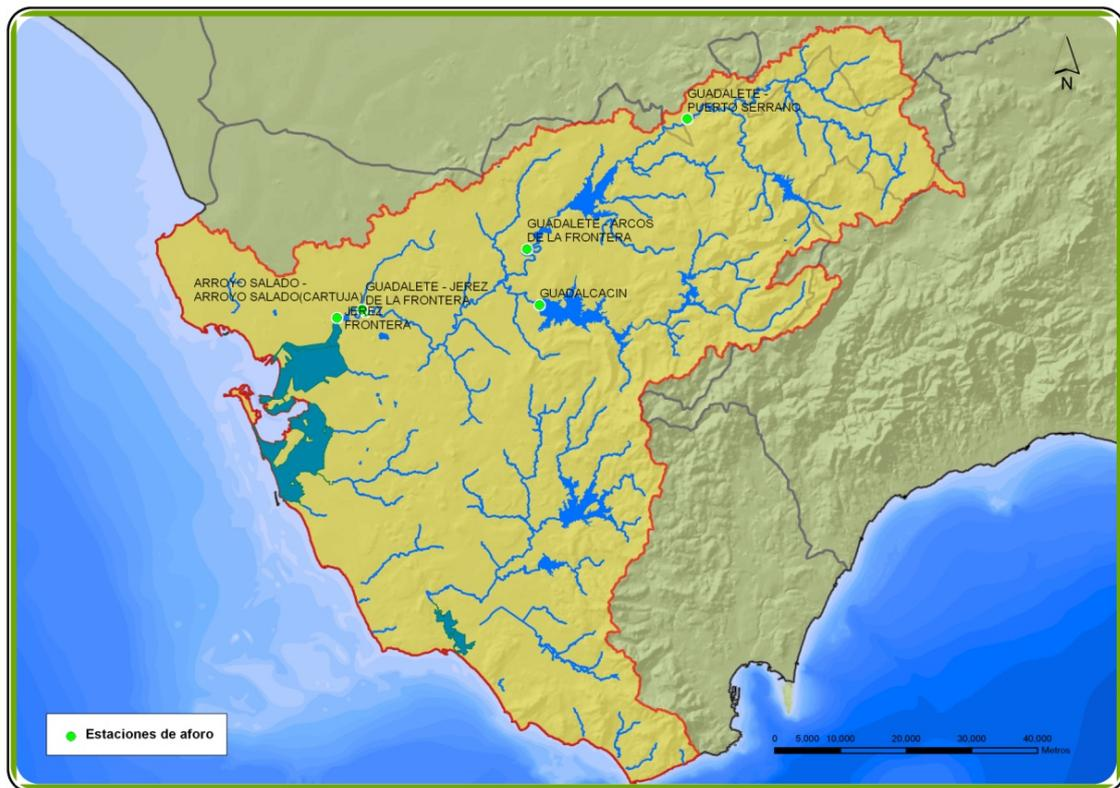
Figura 4.3.3. (1): Estaciones de aforo existentes en la DHGB de las que se dispone de información
