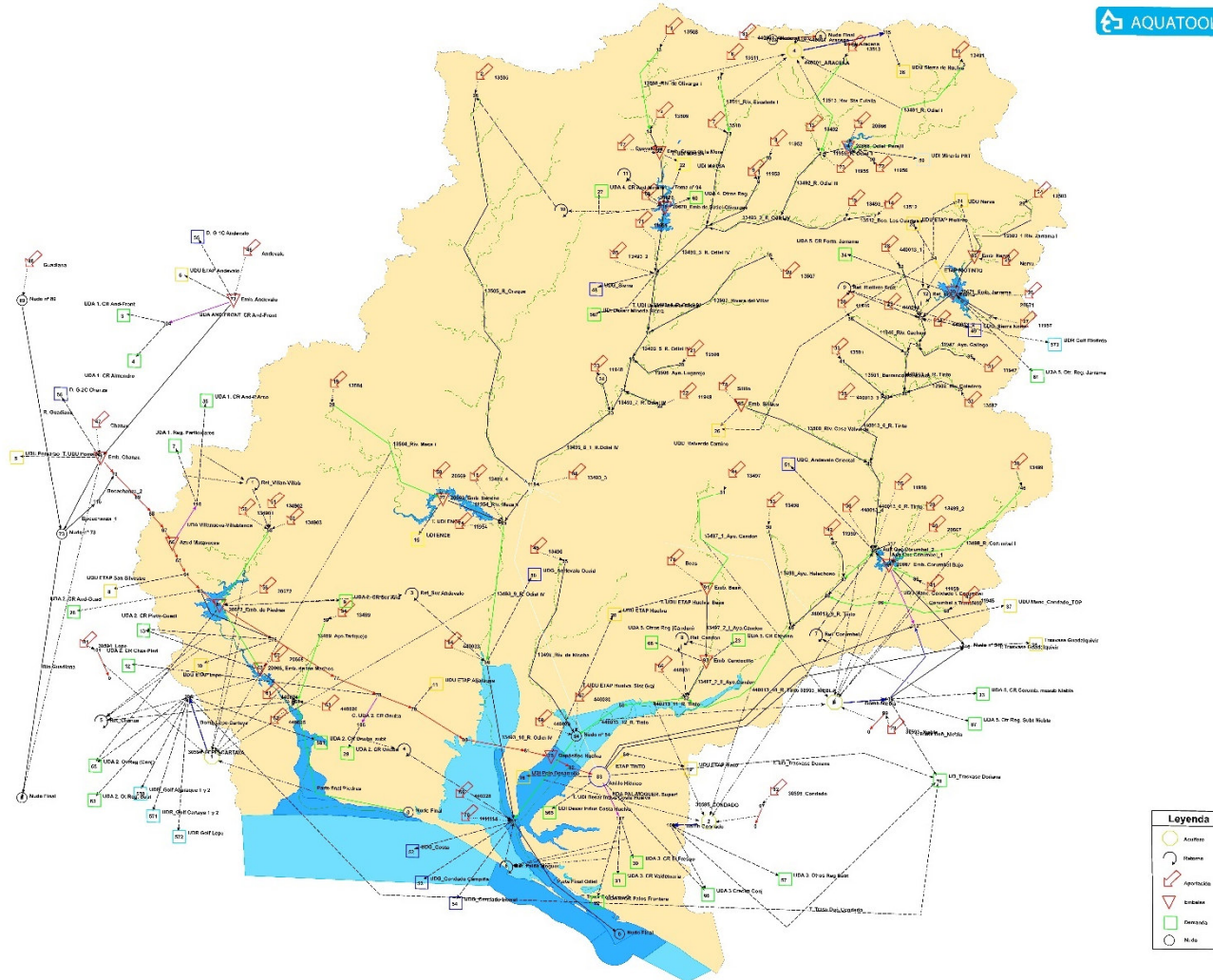
Figura nº 12. Topología del modelo de simulación del sistema de explotación Huelva para el escenario actual
