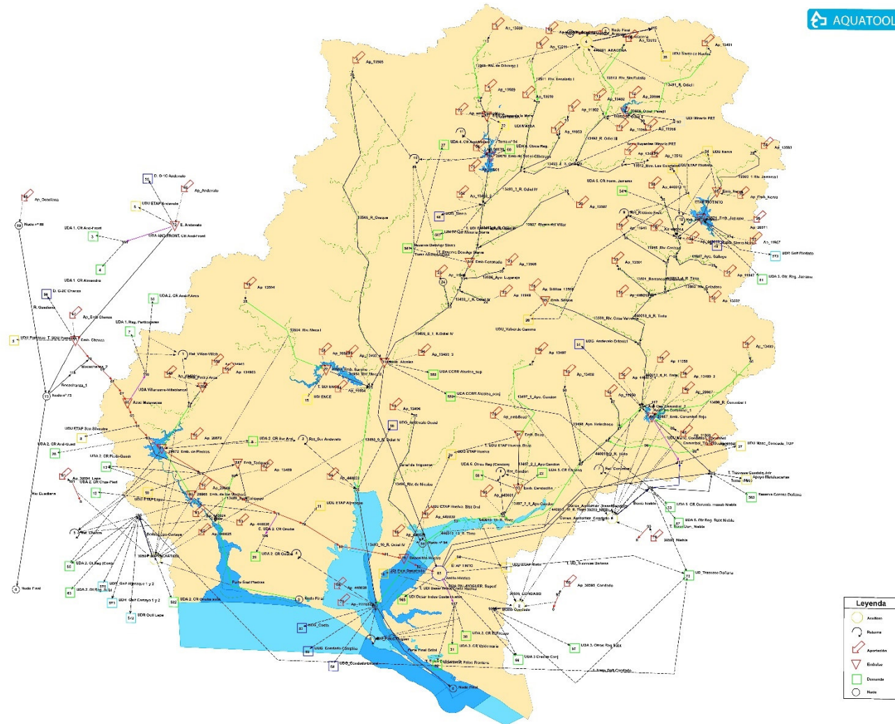
Figura nº 14. Topología del modelo de simulación del sistema de explotación Huelva para el escenario 2039
