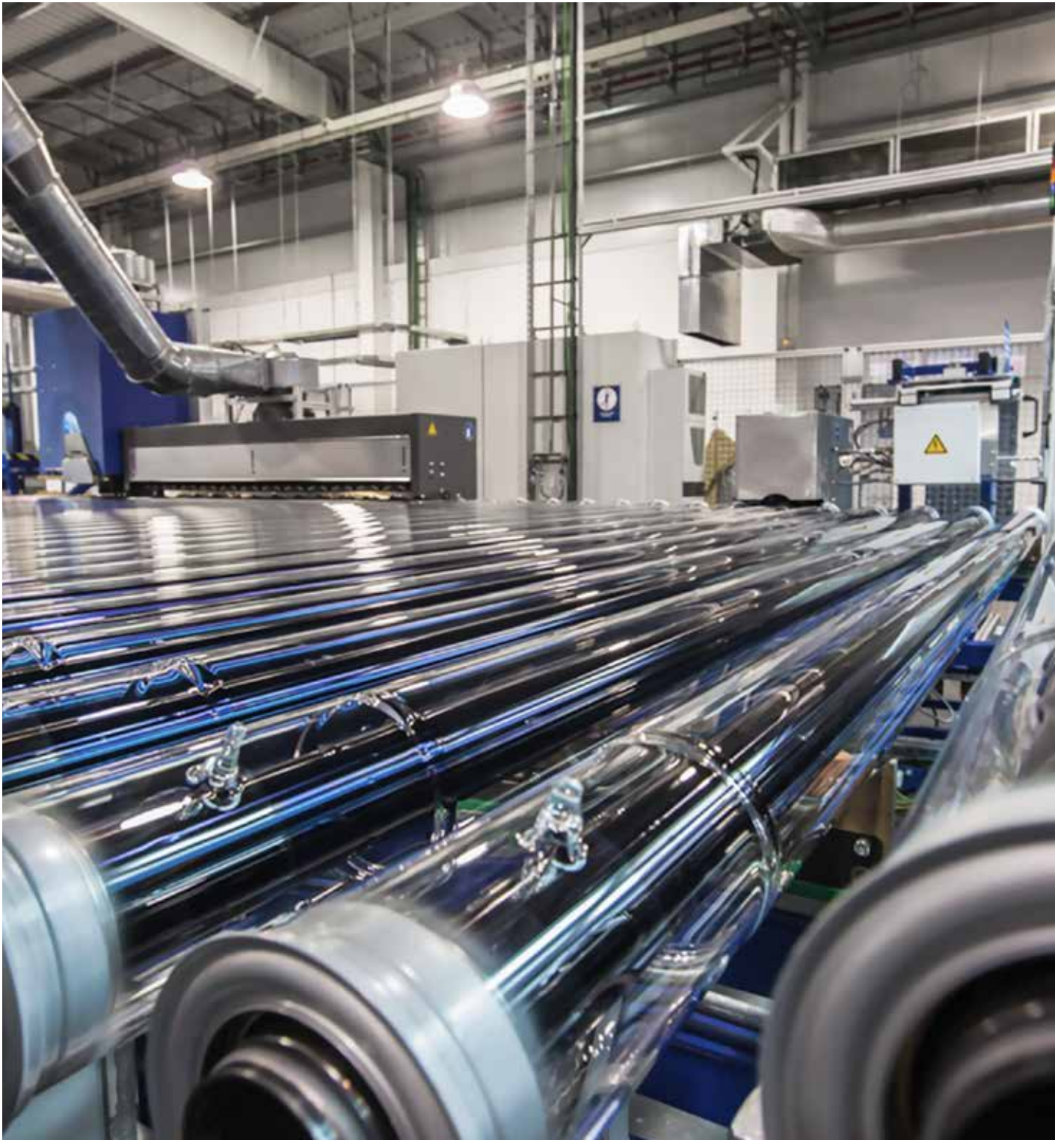
Interior de la fábrica de tubos absorbedores para concentración solar de alta temperatura.
