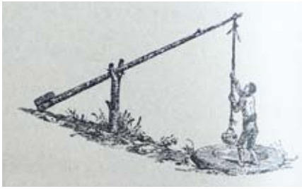
Cigüeña, noria de sangre y bomba manual, ilustraciones de ingenios para la elevación de agua de la obra Arte de la explotación del agua , de Antonio Montenegro, Madrid, 1894. (J. M.ª FERNÁNDEZ-PALACIOS)
