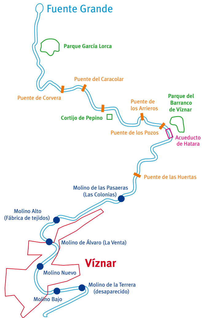
Distribución de puentes, molinos y otros elementos de la acequia de Aynadamar entre el manantial de Fuente Grande, Víznar y El Fargue. (SEGÚN F. GONZÁLEZ ARROYO)
