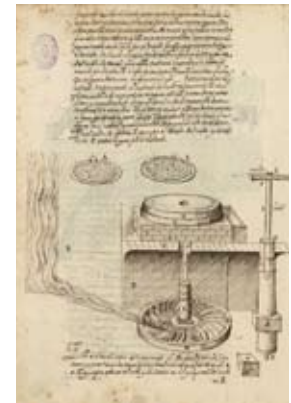
Esquema básico de funcionamiento de un molino hidráulico de cubo y rodezno, en una imagen del tratado Los veintidós libros de los ingenios y de las máquinas , de Pedro Juan de Lastanosa.
