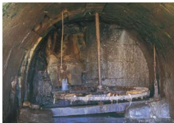
Cárcavo con el rodezno en funcionamiento del molino de la Torre en Alomartes, Íllora (Granada). (J. Morón)
