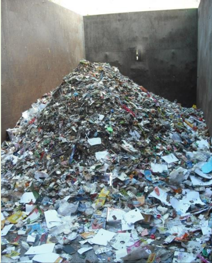
Almacenamiento del rechazo previo al depósito en vertedero
