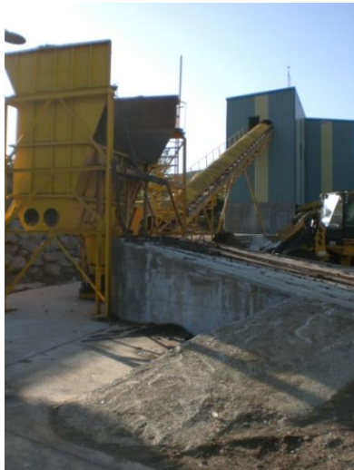
Fotografías nº 42 Tolva de alimentación a la planta de afino
