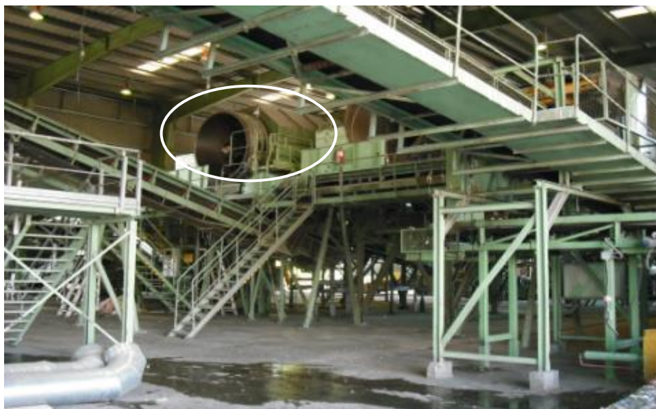
Fotografías nº 53 Trómel de la línea de envases
