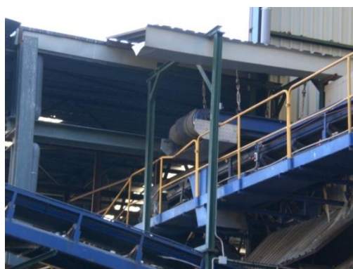
Fotografías nº 39 Separador magnético de la línea de orgánicos
