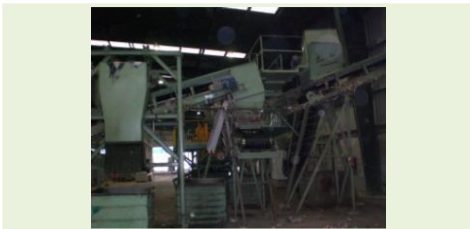
Fotografías nº 77: Separador de electroimán de la línea de orgánicos
