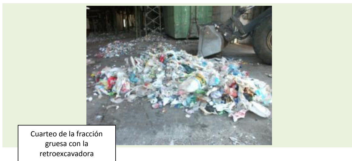
Fotografías nº 71 Procedimiento de toma de muestra fracción de rechazo del segundo afino en trómel (grueso)
