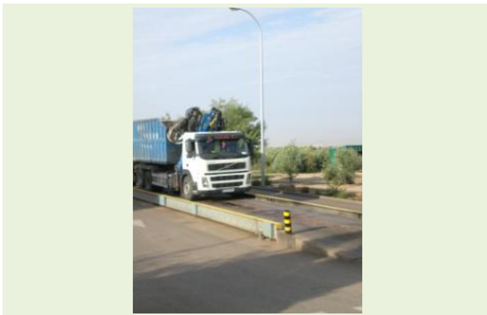
Fotografías nº 73: Báscula de pesaje de vehículos
