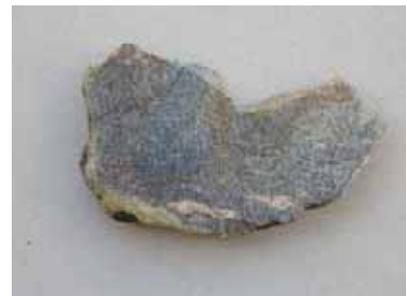
FOTO 141. Detalle de una muestra de mármol de las canteras. La masa blancuzca es el carbonato cálcico del mármol, los puntos oscuros son las impurezas de silicatos y sulfuros. Las pátinas y manchas de óxidos que se observan en la muestra son consecuencia de la alteración superficial de las rocas. De derecha a izquierda la muestra fotografiada mide 11 cm.
