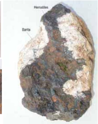
**FOTO 165.** A la derecha, muestra de mano de la mineralización compuesta por barita y hematites. La muestra mide 12 cm en sentido vertical.
