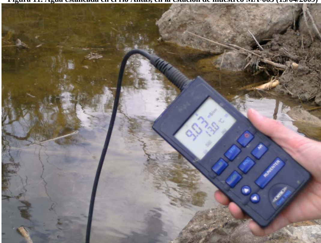
Figura 12. Alta conductividad en el agua estancada del cauce del río Antas (15/04/2009)
