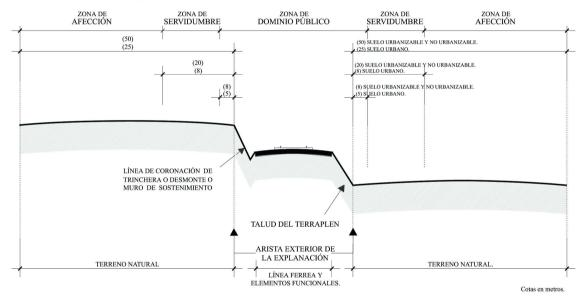
EXPLANACIÓN: Franja de tertreno en la que se ha modificado la topografía natural del suelo y sobre la que se construye la línea férrea, se disponen sus elementos funcionales y se ubican sus instalaciones.
