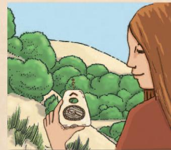
Mantén la brújula horizontalmente delante nuestro, gira el cuerpo hasta que el extremo rojo de la aguja se encuentre exactamente sobre la parte roja de la flecha del Norte. La flecha de la placa base ahora estará señalando la dirección a seguir. Escogeremos un punto de referencia en esa dirección y nos dirigiremos a él, repitiendo el proceso hasta llegar a destino.
