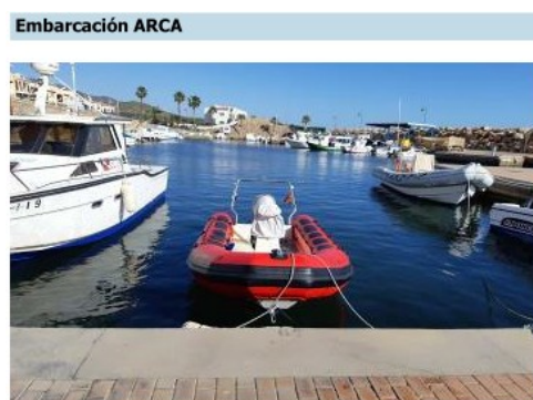
EMBARCACIÓN ARCA CARACTERÍSTICAS DE LA EMBARCACION. Eslora: 6,00 Manga: 2,10 m Puntal: 2,5 m Puerto base: Carboneras Propulsión Motores :HONDA de 130 cv Tripulación: Patrón y Mecánico. Nº máximo de personas a bordo: 6 incluida la tripulación.
