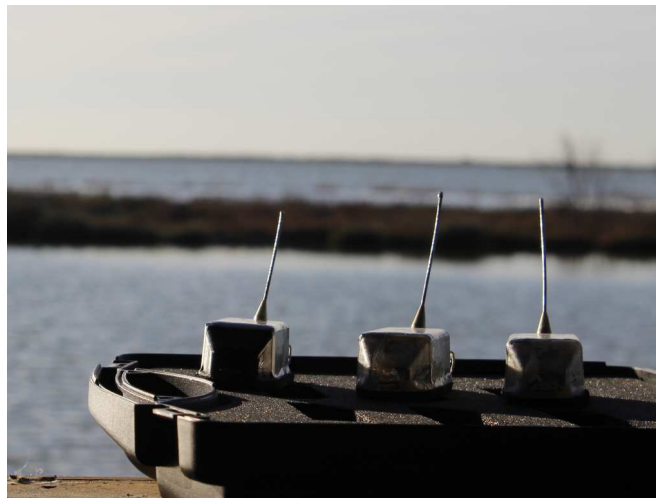
3.- Ejemplo de Prototipos de Emisores de menos de 30g probados en focas.: UHF, VHF, GPS y GPRS, con batería adicional y carga solar.
