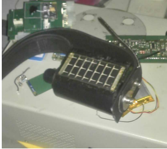
2.- Emisor ruggedizado para grandes mamíferos: UHF, VHF, GPS y GPRS
