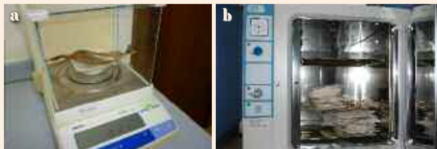
Fig. 11. Matériel utilisé pour la détermination de la dose minimale efficace d'herbicide : balance de précision et étuve dans laquelle sont déposées des enveloppes en papier contenant des échantillons de feuilles traitées.
