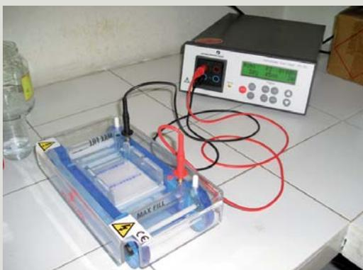
La electroforesis es un método para mover sobre un gel distintos fragmentos de ADN (en este caso) a través de la corriente eléctrica y separarlos en función de su tamaño. Posteriormente se visualizan con luz ultravioleta y se analiza cuánto se han desplazado (RGA).
