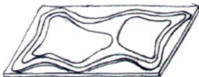
La primera plancha se recorta con la forma y tamaño que se elija para la maqueta. Con una fotocopia ampliada de la zona escogida se señala, perforando con un punzón, sobre la segunda plancha la curva de nivel exterior, cortándola después con una cuchilla. Una vez cortada se pega sobre la primera plancha. Se realizará lo mismo con las siguientes.
