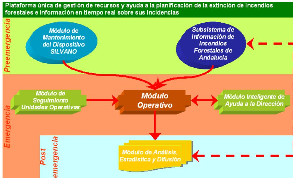
**Figura 1**—Esquema básico del Sistema Integrado para la Gestión y Dirección de Incendios Forestales en Andalucía SIGDIF.
