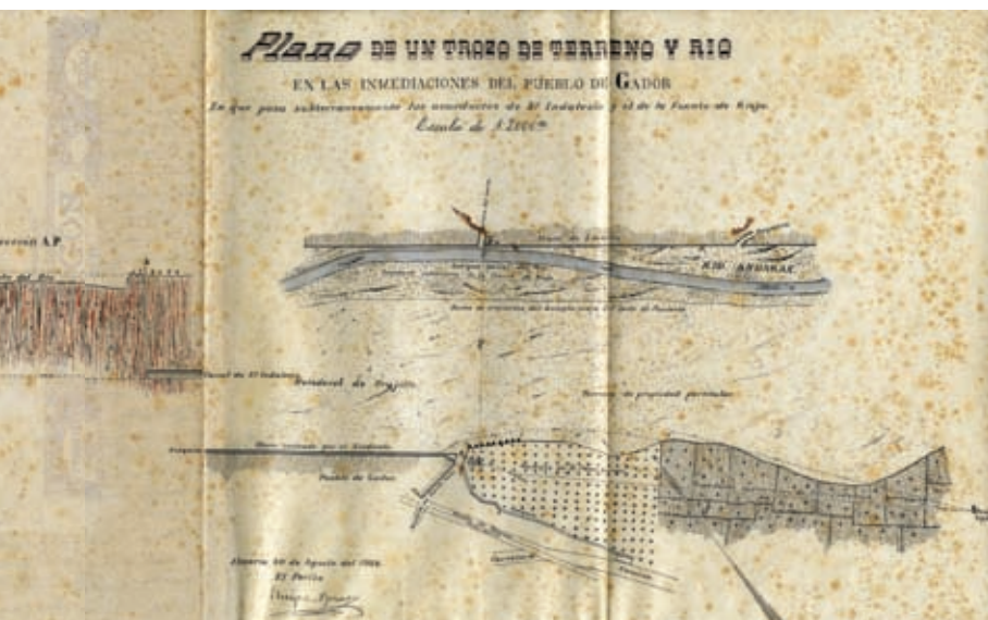
Arriba, plano de las fuentes de Almería o de Alhadra conocidas como la Larga y la Redonda en 1904, donde puede apreciarse la longitud y profundidad de sus galerías subterráneas. Archivo del Sindicato de Riegos de Almería y Siete Pueblos de su Río. Colección Dolores Segura del Pino.
