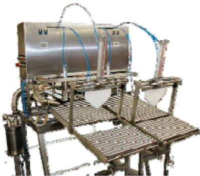
Los envases de tetrapack se llenan con máquinas llenadoras de simple diseño y por lo tanto la inversión en ellas está al alcance de cualquier industria. Están fabricadas en acero inoxidable, y solo requieren conectarse a una línea de aire comprimido, electricidad y suministro del elemento a envasar. Su operación es simple, semiautomática o full-automática.
