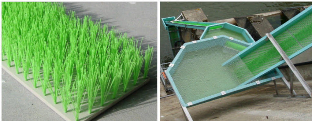
Figura 13. Detalle de estera de cerdas para la subida de anguilas (izquierda). Disposición de rampas y cajas o codos de reposo en una escala donde además se aprecian las esteras de cerdas mixtas con distinta separación entre cerdas para evitar la selectividad del paso (derecha) (Fotos: www.fish-pass.fr ).
