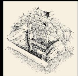
O moleiro, para além de utilizar a roldana, mediante a alavancagem de um pau contra a parede, subia e descia as comportas para deixar passar o caudal de água necessário.
