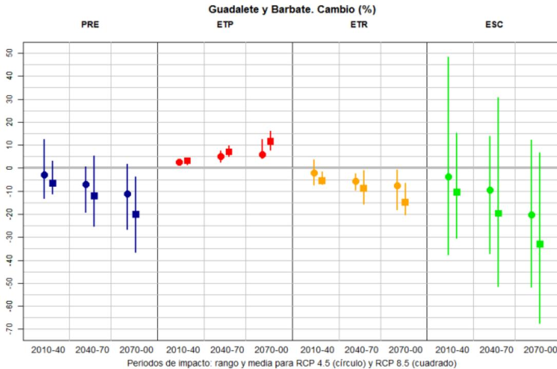
Figura nº 8. Cambio (%) en las principales variables hidrológicas en los tres PI respecto al PC para la DHGB. Rango y media de resultados para RCP 4.5 (círculos) y RCP 8.5 (cuadrados). (CEDEX, 2017)
