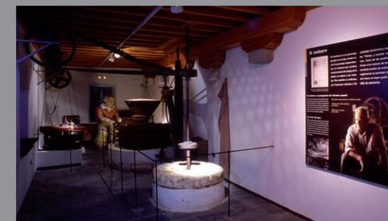
El giro de los *rodeznos* transmitía el movimiento, ya en el interior de la sala, a un eje sobre el que suspendía una piedra de moler (*volandera*), que por rozamiento con otra fija trituraba el grano vertido a través de la tolva de madera que todavía podemos observar en la sala de molienda.
