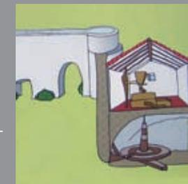
El ingenio aprovechaba la energía del agua, que era conducida desde el cauce del río por una acequia llamada *cao* hasta un pozo o depósito (cubo). Desde aquí el agua almacenada era liberada y dirigida a presión sobre una rueda con aspas (rodezo), que mediante un eje transmitía el giro a una piedra móvil (corredera o volandera), por encima de otra fija (solera). El grano, vertido entre
