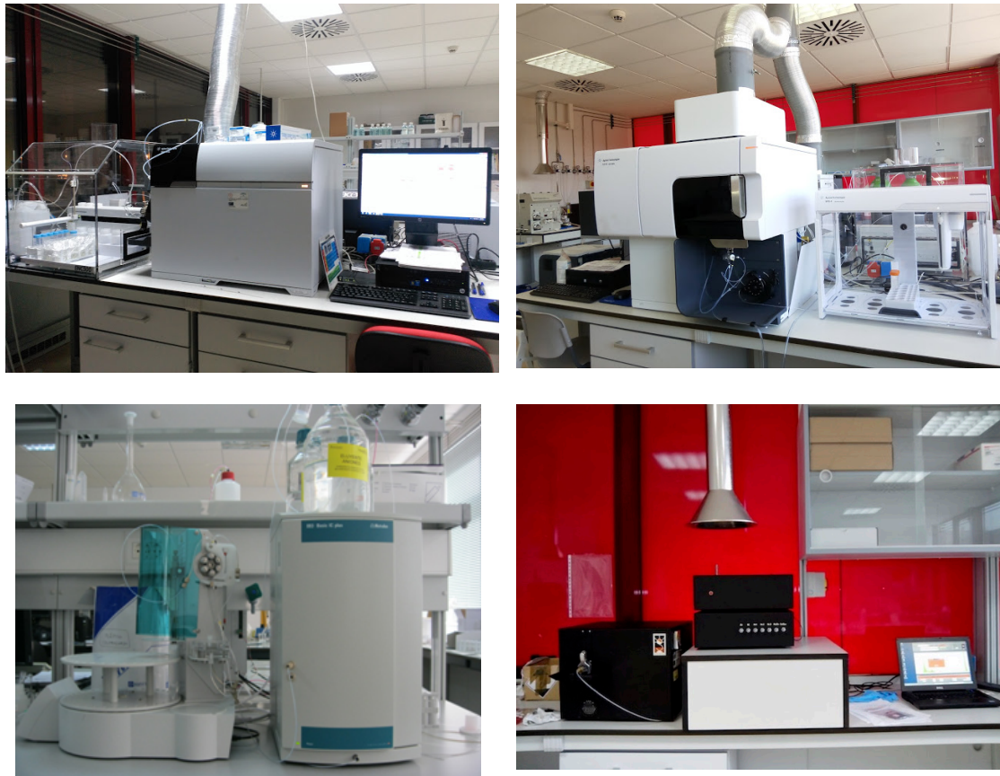
Figura 1.- Instrumentación empleada en el análisis de elementos traza (ICP-MS, Agilent 7900), mayores (ICP-OES, Agilent 5110), iones (Cromatografía Iónica, Methrom) y especies de C (Sunset), respectivamente.
