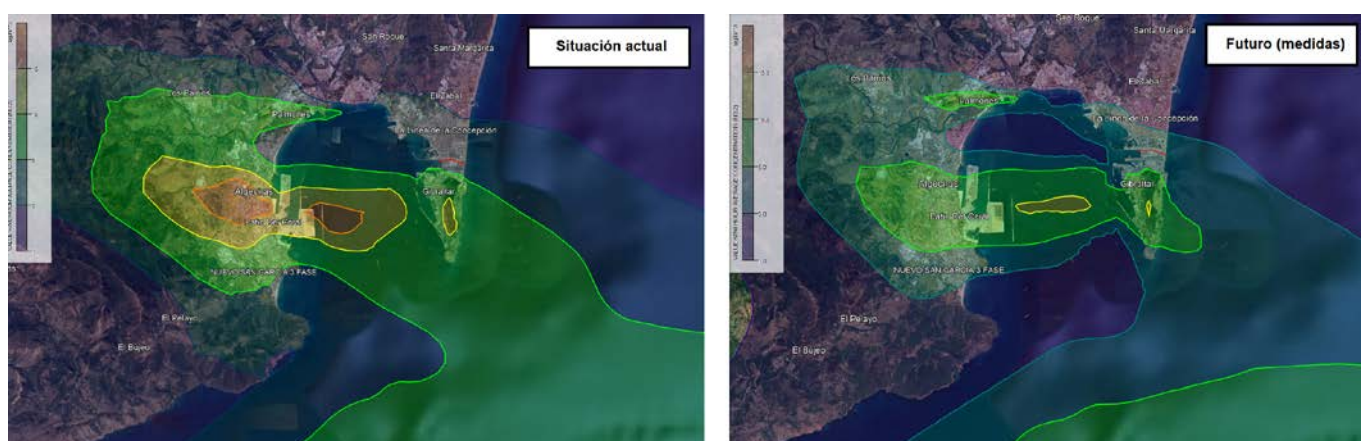
Figura AII.13. Contribución del tráfico marítimo a los niveles medios anuales de inmisión de NO 2 en la Bahía de Algeciras -Ampliación- (comparación de la situación actual y futura, con medidas)
