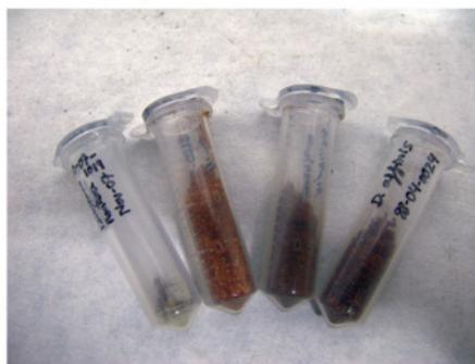
**Conservación de esporas a 5<sup>º</sup> C** en cámara frigorífica, utilizando contenedores herméticos de vidrio en los que se introduce el material vegetal en eppendorf o tubos de ensayo de pequeño volumen, en condiciones de desecación (gel de sílice). Este método se ha empleado para esporas no cloroflicas, que presentan un comportamiento similar a las semillas ortodoxas, como es el caso de la mayoría de especies de Pteridófitos en Andalucía.
