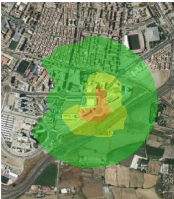
Figura 4: Modelo de dispersión para HCl. Naranja (hasta  $3 \mu\text{g}/\text{m}^3$ ). Amarillo (hasta  $2 \mu\text{g}/\text{m}^3$ ). Verde (hasta  $1 \mu\text{g}/\text{m}^3$ ). Fuente, VIS persona promotora.
