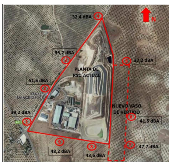
Figura 10. Ubicación puntos de control y niveles sonoros en barrido (Estudio Acústico, fuente EsIA)
