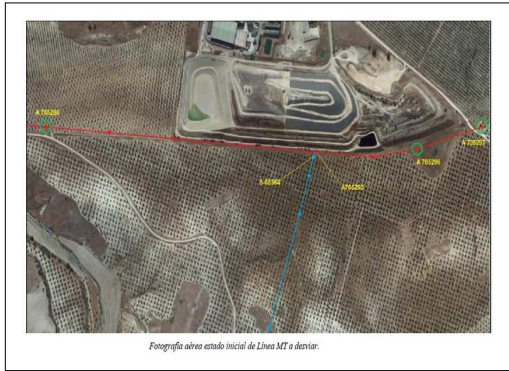
Figura5: Estado Línea Eléctrica y desvío y soterramiento previsto.
