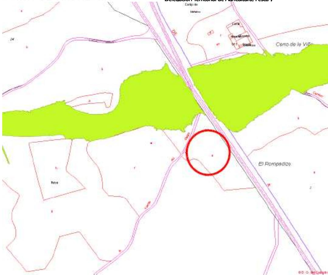
Imagen 2: Zona inundable para T=500 años con referencias catastrales. El círculo indica la ubicación prevista para la Planta de Biogás
