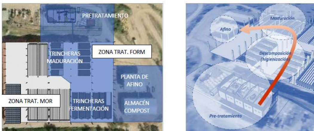
Espacios de la actual instalación utilizados para el compostaje diferencial de la FORS
