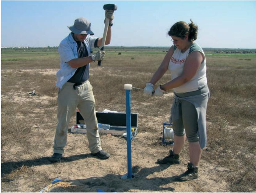
Colocación por hinca de un tubo piezométrico en un sondeo iniciado con barrena manual, en La Vera.
