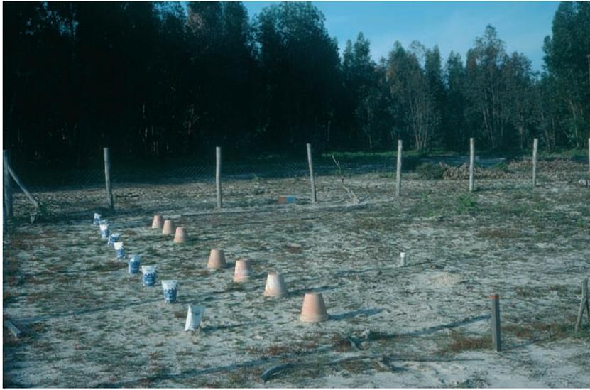
Instalación de tensiómetros para estudiar la recarga, en una experiencia del IGME anterior a 1990. Los tientos invertidos son una protección de las cabezas de los tensiómetros. Parcela próxima a Hato Villa, en La Vera. Foto: EC.
