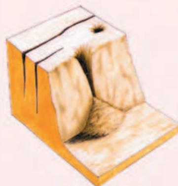
Desprendimiento en masa
