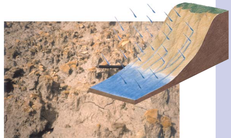
Chimeneas de hadas: pequeños montículos de suelo protegidos de la erosión laminar por fragmentos de roca más resistentes.
