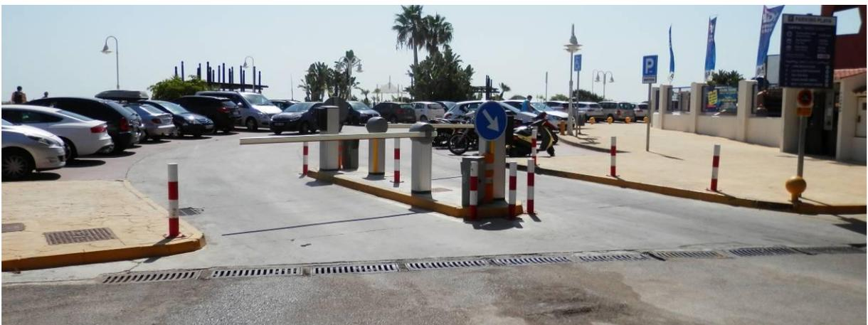
Foto A1.5. Acceso al aparcamiento y vial. Imbornales para drenaje de pluviales
