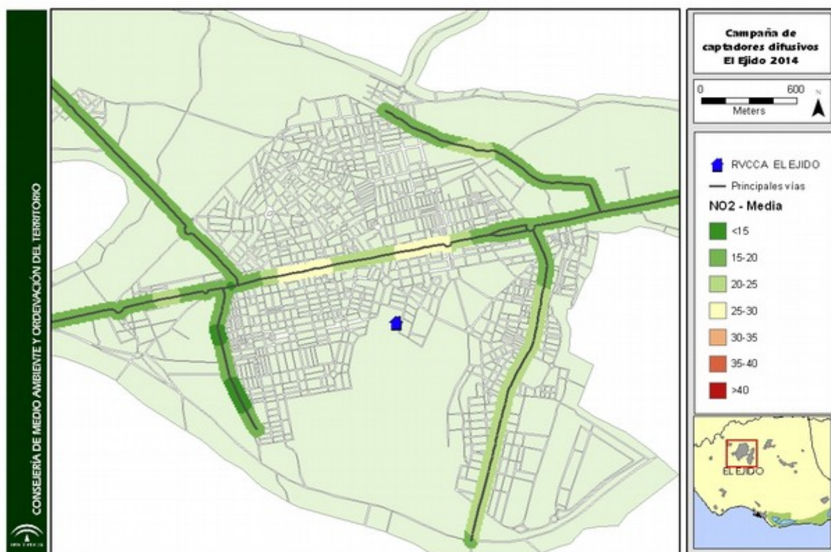
Figura I.100. Media anual de NO 2 (µg/m 3 ) para los captadores de tráfico. Campaña de El Ejido 2014.
