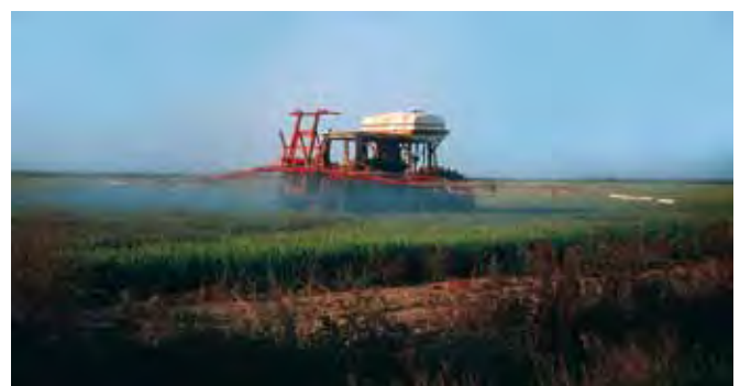
Fig. 8.25.- Tractor provisto de ruedas más altas para tratar piricularia. (J. M. García Cano)
