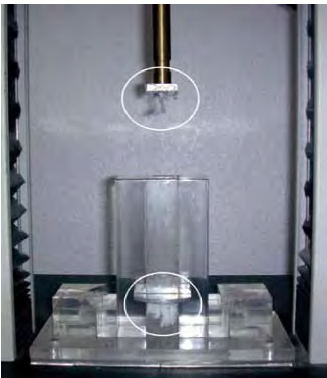
Fig. 10.12.- Instron: determinación de la consistencia del grano.
