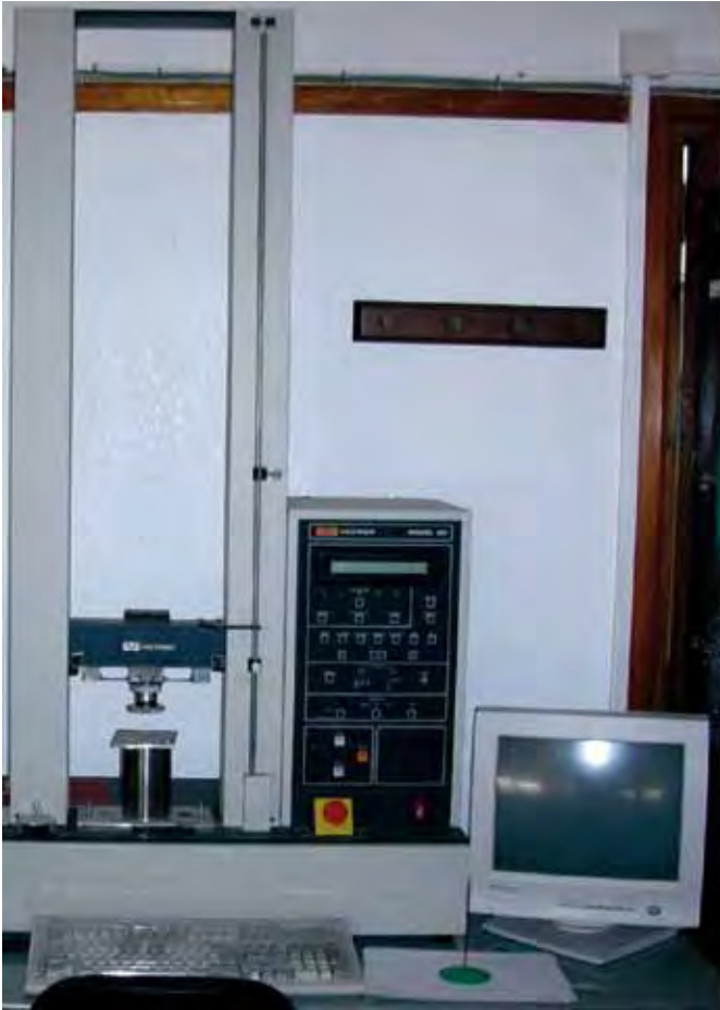
Fig. 10.11.- Instron: inicio de la determinación de la adhesividad del grano.
