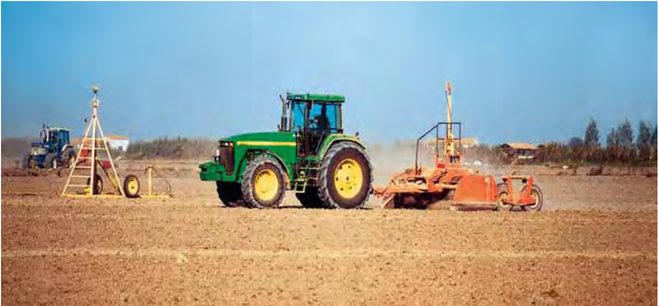
Fig. 3.7.- Nivelación guiada por rayo láser
