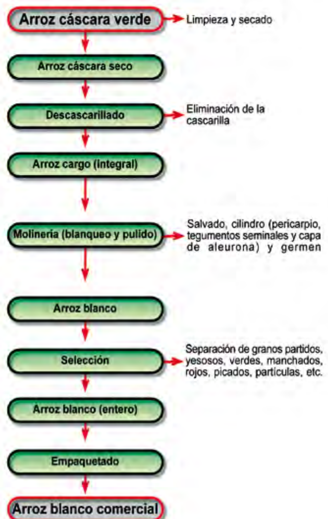
Fig. 10.1.- Elaboración del arroz. Esquema del proceso industrial.
