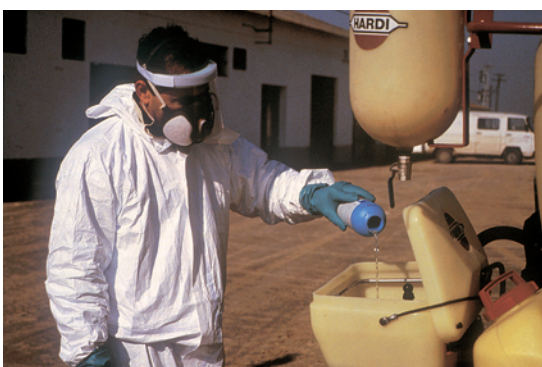
Figura 1. Adecuada protección personal en la preparación del caldo de tratamiento
