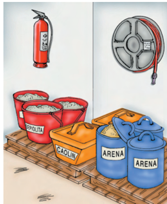
Figura 4. Disposición de las medidas de seguridad necesarias en los locales de almacenamiento
