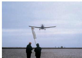
Figura 3. En tratamientos aéreos la avioneta nunca debe pasar por encima del ayudante
