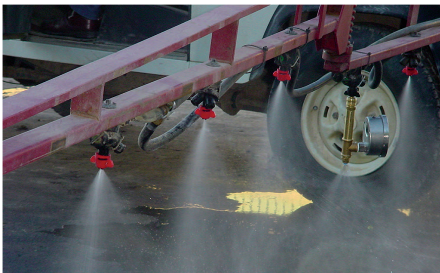
Figura 4. Para conseguir una buena uniformidad es necesario comprobar que las boquillas expulsan el mismo caudal
